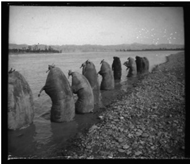
Figure 4. Kan-sou [Gansu], Peaux de bœufs remplies à demi de blé et gonflées pour former un radeau et descendre le fleuve jusqu'à Ning-hia [Ningxia], 24 octobre 1909, 5,8 cm x 12,8 cm, Paris, Bibliothèque nationale, de France, Département des estampes et de la photographie (n° EI2-58-123).
